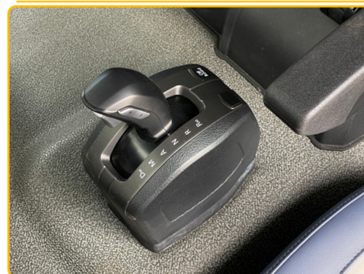
■ گیربکس اتوماتیک مجهز به ریتارد هیدرولیکی
