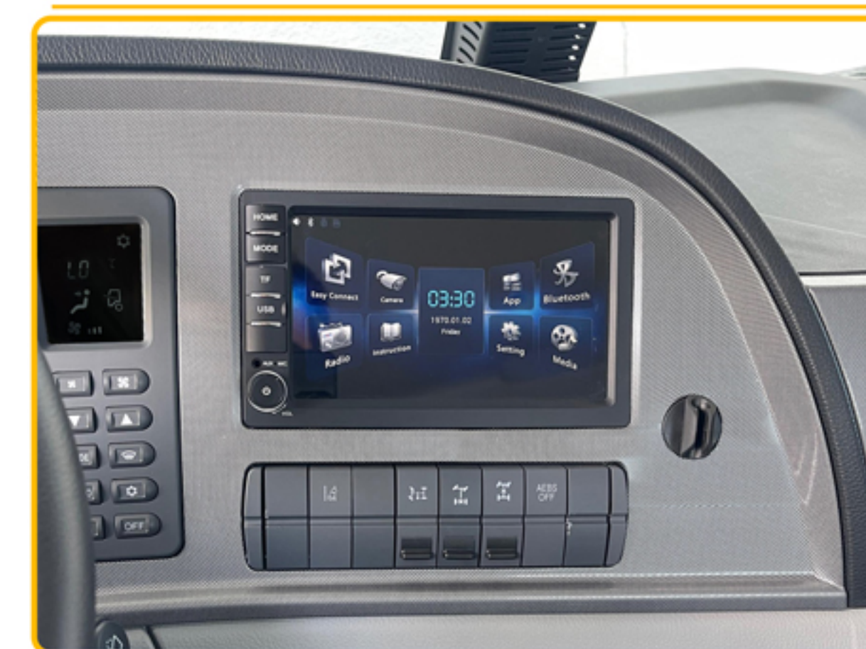
■ سیستم مولتی‌مدیا TFT لمسی (رادیو، رهیاب، بلوتوث، USB، SD Card)
