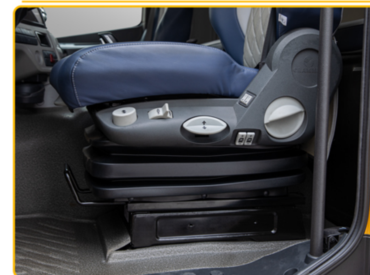
■ صندلی راننده با تعلیق پنوماتیکی و قابلیت تنظیم در ۶ جهت
